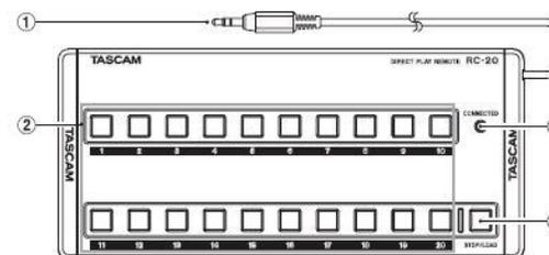
① **Anschlusskabel mit 2,5-mm-Klinkenstecker** (Spitze: Signal, Ring: Versorgungsspannung, Hülse: Masse)
